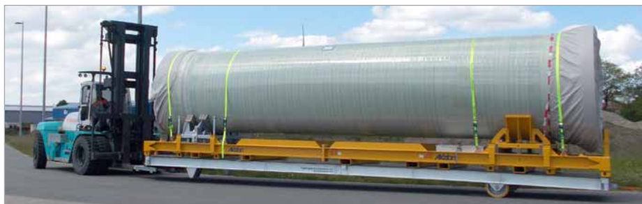
Für den Transport von extrem schweren und sperrigen Teilen: Länge 12 m, Tragfähigkeit 20 t
