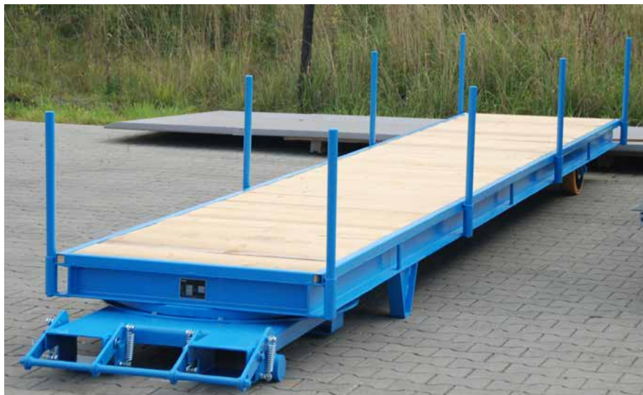
STS mit Rungen (Sonderausführung)
