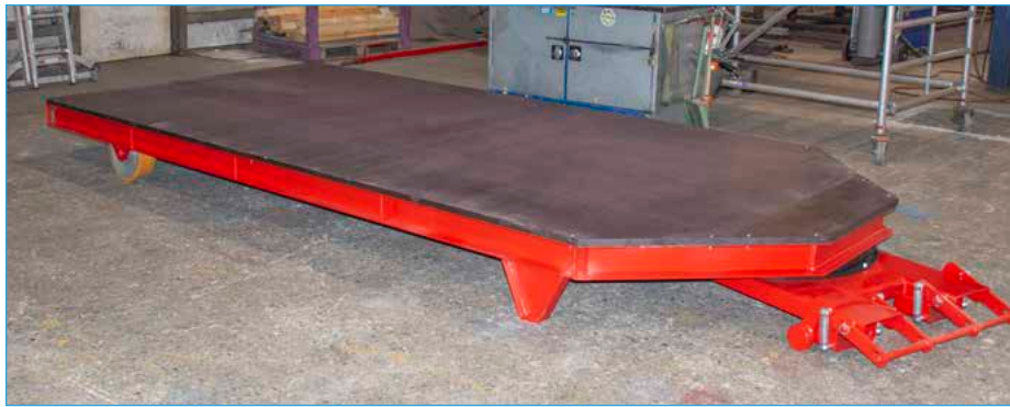
STS mit rutschhemmenden Betosiebplatten
