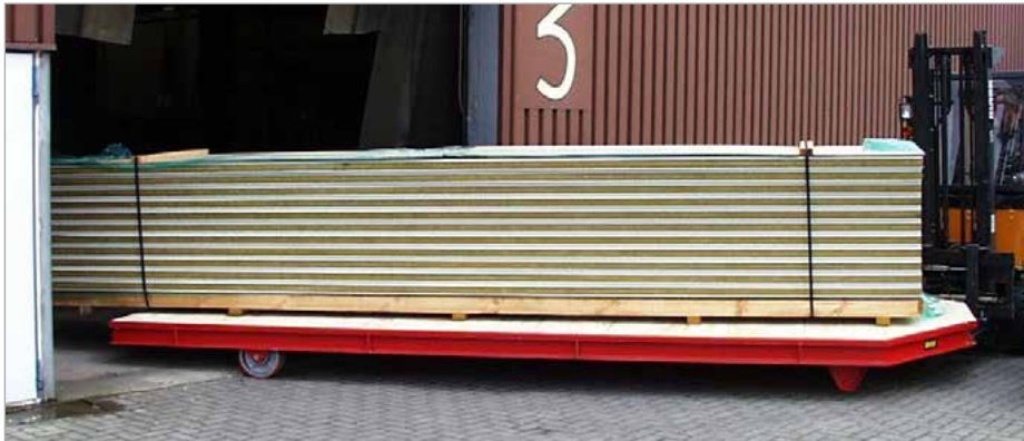
Transport von Langgütern; kleiner Wendekreis durch Direktaufnahme
