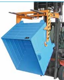
Entleerung mittels Traverse oder Drehgerät
